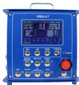
Контроллер многофункциональный шахтный Конвейер
