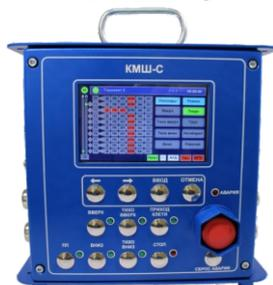
Контроллер многофункциональный шахтный ШСС-Стволовой
